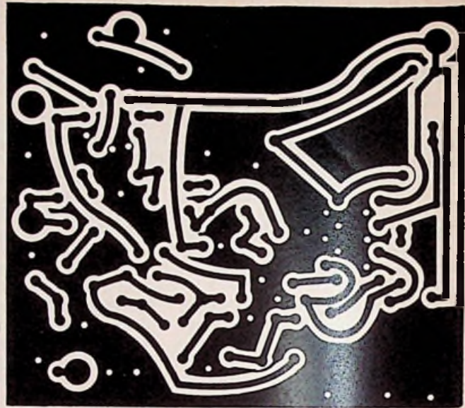
Fig. 4a en b. Onderdelenopstelling en lay-out van de intercomprint voor de hoofdpost.
